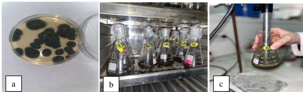
Figure 11 :Expériences de confirmation (a : la souche Penicillium sp ; b : Fermentation solide sur grignons d'olives ; c : Broyage à l'aide de l'ultraturrax)
